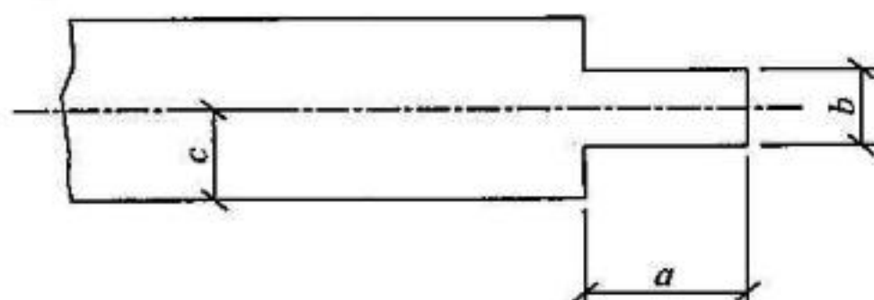
图 6.2.2-3 构件的榫头加工
