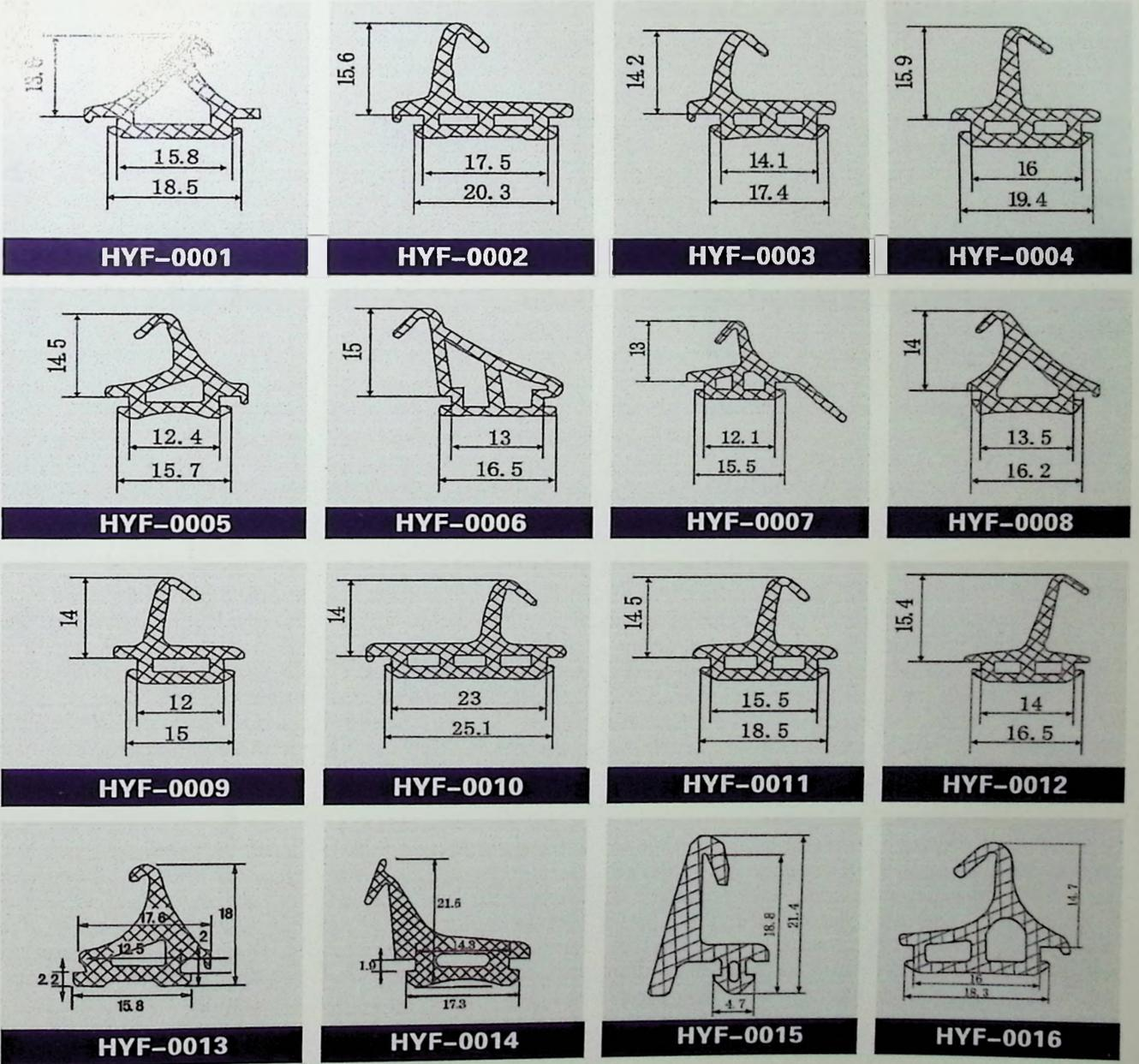
断桥铝框扇密封胶条断面图
